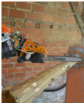
Robot usinant un tronçon © Manufacture du châtaignier
